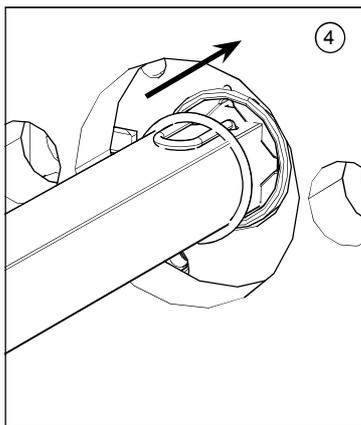
3. Sicherungsklammer positionieren und eindrücken.
