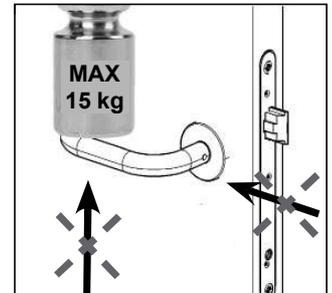
Der Drücker darf nur im normalen Drehinn belastet werden. In Betätigungsrichtung darf auf den Drücker (maximal) nur eine Kraft von 15 kg aufgebracht werden.
