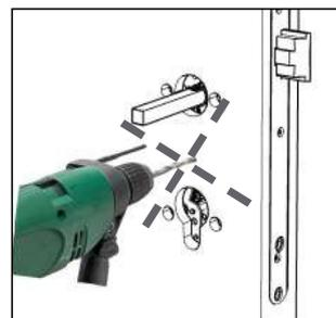
Das Türblatt darf im Schlossbereich nicht bei eingebautem Schloss durchbohrt werden.
