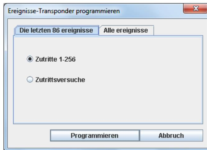
Ein Transponder kann bis zu 86 Ereignisse speichern. Wenn mehr Ereignisse aus einer Schliessung ausgelesen werden sollen, müssen mehrere Auslese-Transponder angelegt werden. Diese mehreren Auslese-Transponder werden unter Alle „ereignisse erstellt“.
