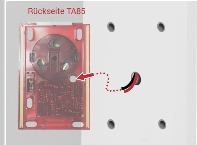
Ziehen Sie die Kabel durch das Loch des Gehäuses, das für die Kabel auf der Rückseite vorgesehen ist, hindurch.
