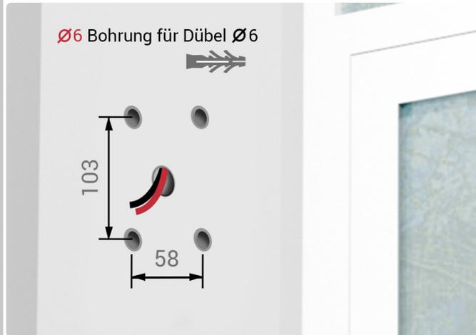
Bohren und setzen Sie die mitgelieferten Dübel in die Löcher ein.
