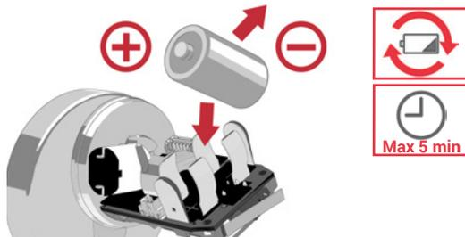
Alte Batterie entnehmen und ersetzen.
