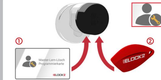
Zum Programmieren des Zylinders: Immer zuerst (1) die Masterkarte an den Zylinder halten, danach (2) den Transponder
