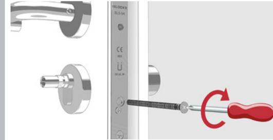
ELOCK2 Zylinder mit der Stulpschraube fixieren
