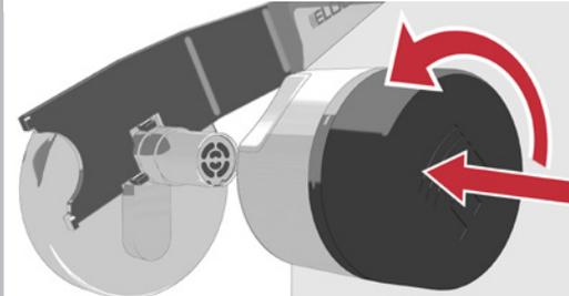
Den Außenknopf linksdrehend (gegen Uhrzeigersinn) montieren
