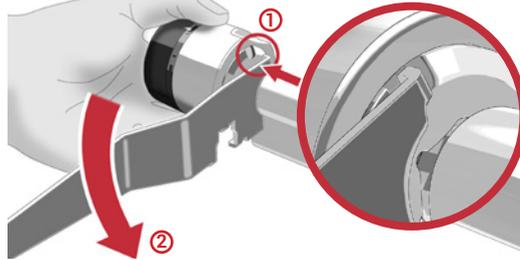
Den Montageschlüssel am Außenknopf in die Einkerbung ansetzen, den Außenknopf entriegeln (1) und demontieren (2)
