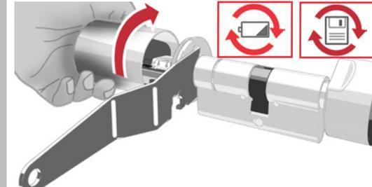
Den Montageschlüssel in die Einkerbung des Innenknopfs ansetzen. Mit der anderen Hand den Knopf aufschrauben.
