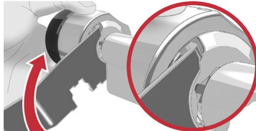
Montageschlüssel in die Einkerbung ansetzen, den Außenknopf festhalten und fixieren
