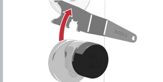
Den Montageschlüssel von der Arretierposition entnehmen
