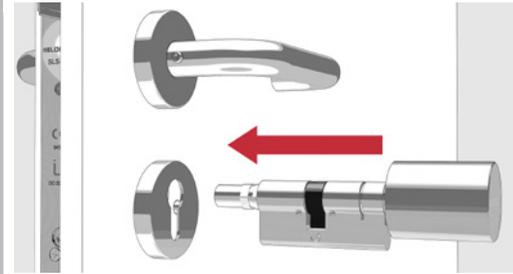
Den ELOCK2 Zylinder von der Türinnenseite durch die Profilzylinder-Bohrung einschieben.
