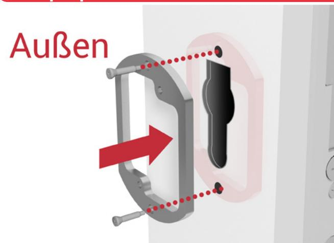
Montieren Sie die Adapterplatte an den Löcher, die für die Montage gebohrt worden sind.
