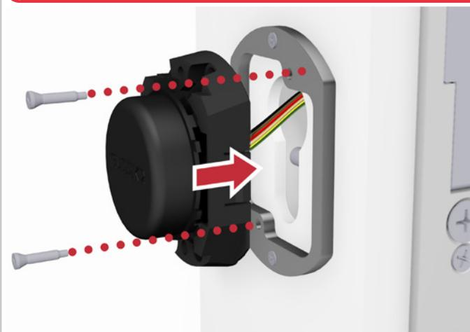
Montieren Sie die Antenne auf den Antennenadapter
