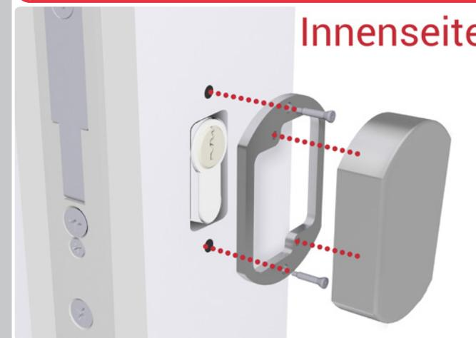
Montieren Sie auf der Innenseite die Blindrosette
