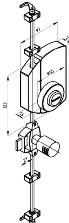
Speziell geeignet für Drehtüren mit Drehstangenschlössern
