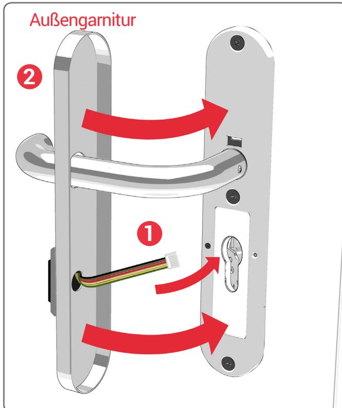
**C** Innenschild mit Antenne über den Griff führen und Antennenkabel an das Schloss anschließen.
