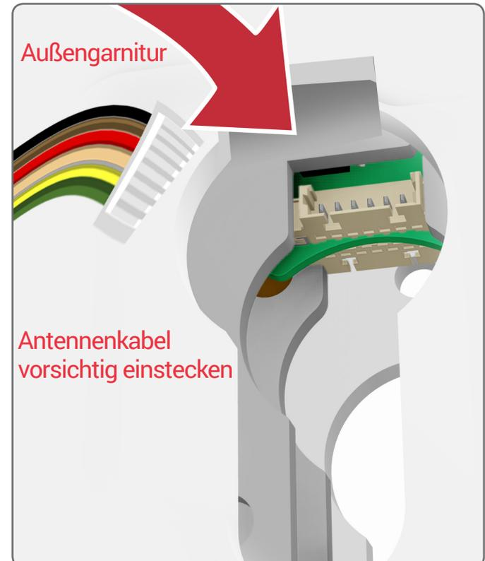
**D** Steckplatz des Antennenkabels.
