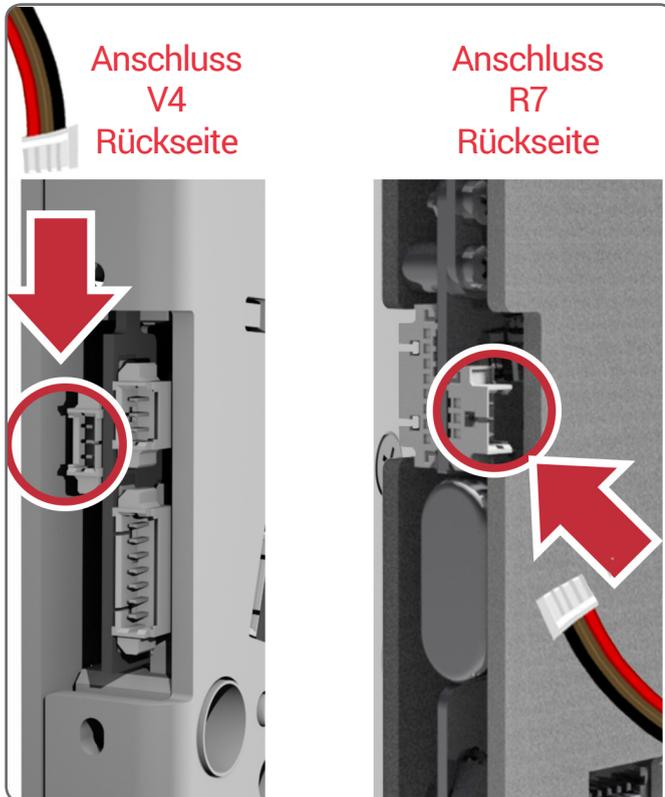
**A** Kabel für die Verbindung zwischen dem Schloss und H9 erst am Schloss einstecken (Schlosskabel).
