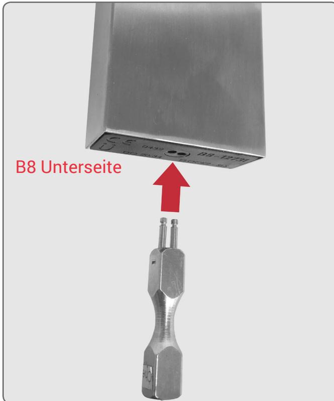
**A** Spezialwerkzeug 704.B8 in die Unterseite des B8B in die zwei Löcher einstecken
