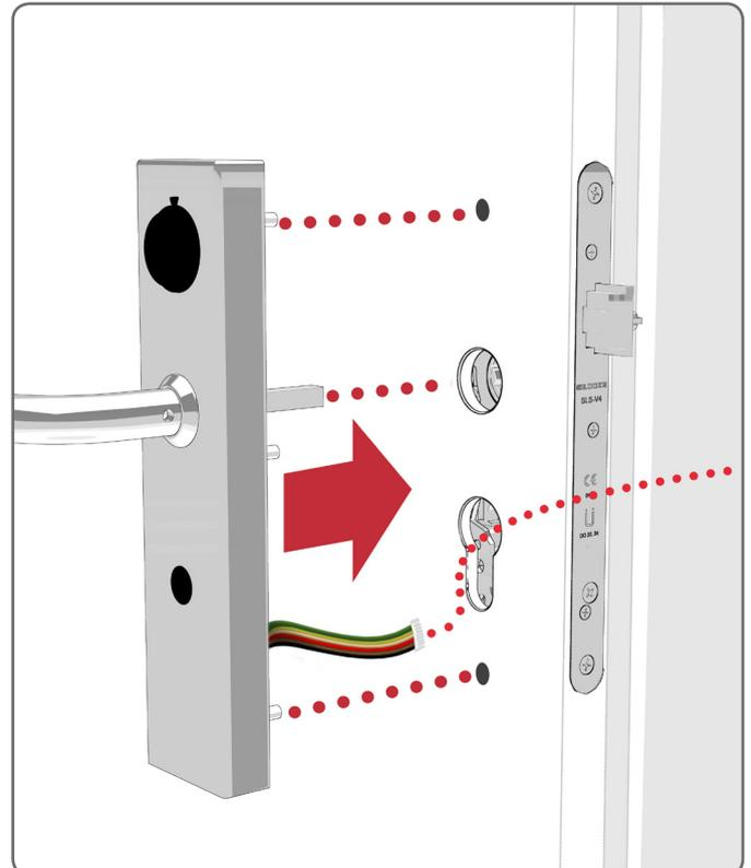
**D** Kabel des B8B durch das PZ-Loch führen.
