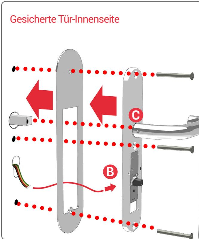
**A** -Dekorplatte hinhalten, B8B-Kabel durchführen und an H9 anschließen (Siehe B)
