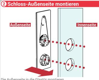
Die Außenseite in die Glastür montieren. Achtung: Einklemmen des Antennenkabels verhindern!
