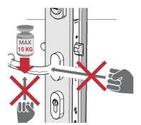
Der Drücker darf nur im normalen Drehsinn mit maximal 15 kg belastet werden.
