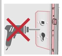
Das Türblatt darf im Schlossbereich nicht bei eingebautem Schloss durchbohrt werden.
