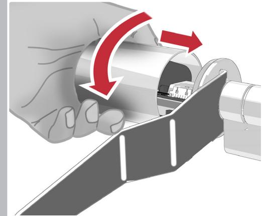
Montieren Sie nach dem wechseln der Batterie den Innenknopf wieder zusammen.
