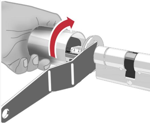
Den Montageschlüssel an Ihrem Innenknopf in die Einkerbung ansetzen, den Außenknopf entriegeln und demontieren.
