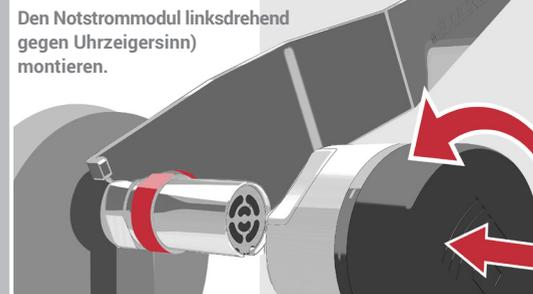
Den Notstrommodul linksdrehend gegen Uhrzeigersinn) montieren.
