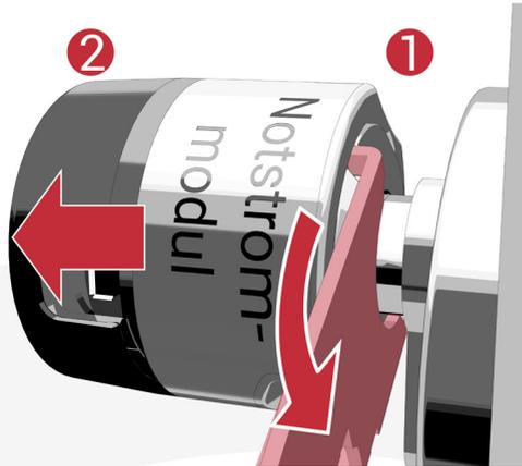
Auf der ungesicherten Außenseite kann jetzt das Notstrommodul wieder demontiert werden.
