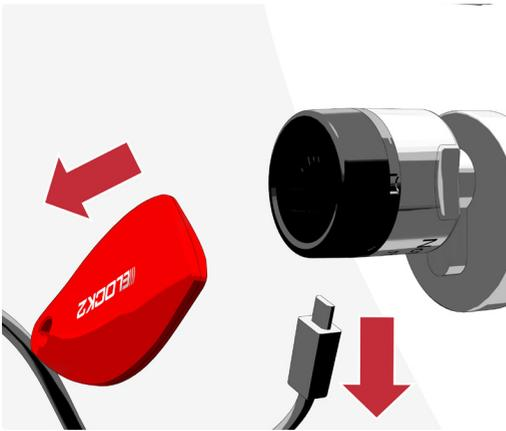
Nach Öffnen der Tür, Kabel vom Notstrommodul bzw Außenknopf (Modell BIS 2015) wieder ausstecken.
