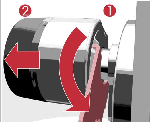
Den Montageschlüssel an Ihrem Außenknopf in die Einkerbung ansetzen, den Außenknopf entriegeln (1) und demontieren (2)
