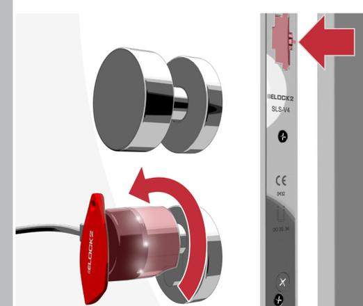
Den Kabel am Notstrommodul bzw Außenknopf (Modell BIS 2015) stecken lassen und mit einem BERECHTIGTEN Transponder die Tür öffnen
